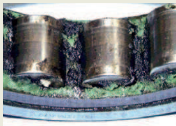
Деградация смазки, вызванная прохождением электрического тока
