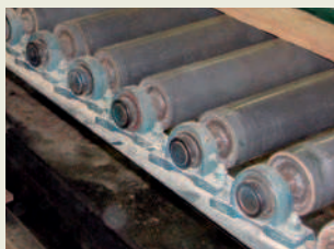
Перегрев подшипника конвейера
